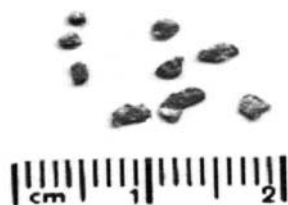
Снимка 1. Златни кристали със сферична и пластинчатата форми с размери -2.0+1.25\text{mm}
