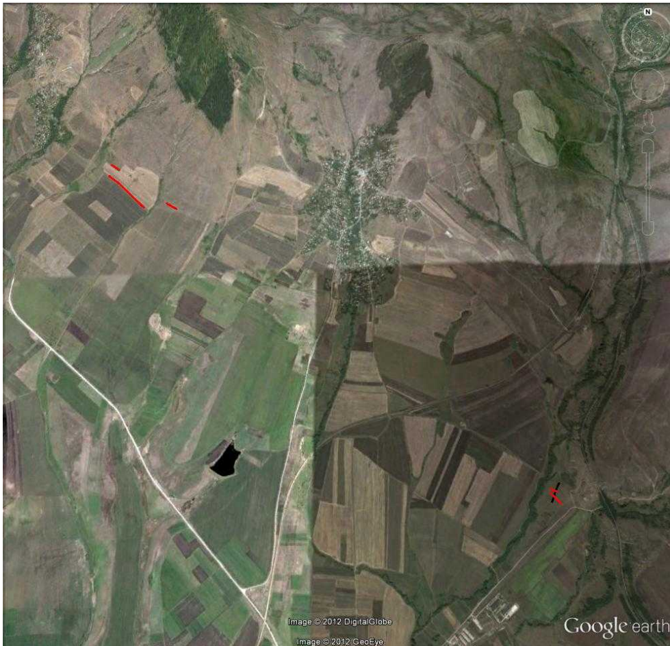
Фиг. 1.3. Карта на наблюдаваните косеизмични геоложки ефекти. Червените линии показват участъците с пукнатини на земната повърхност. Черната линия: мястото на електросъпротивителния профил.
